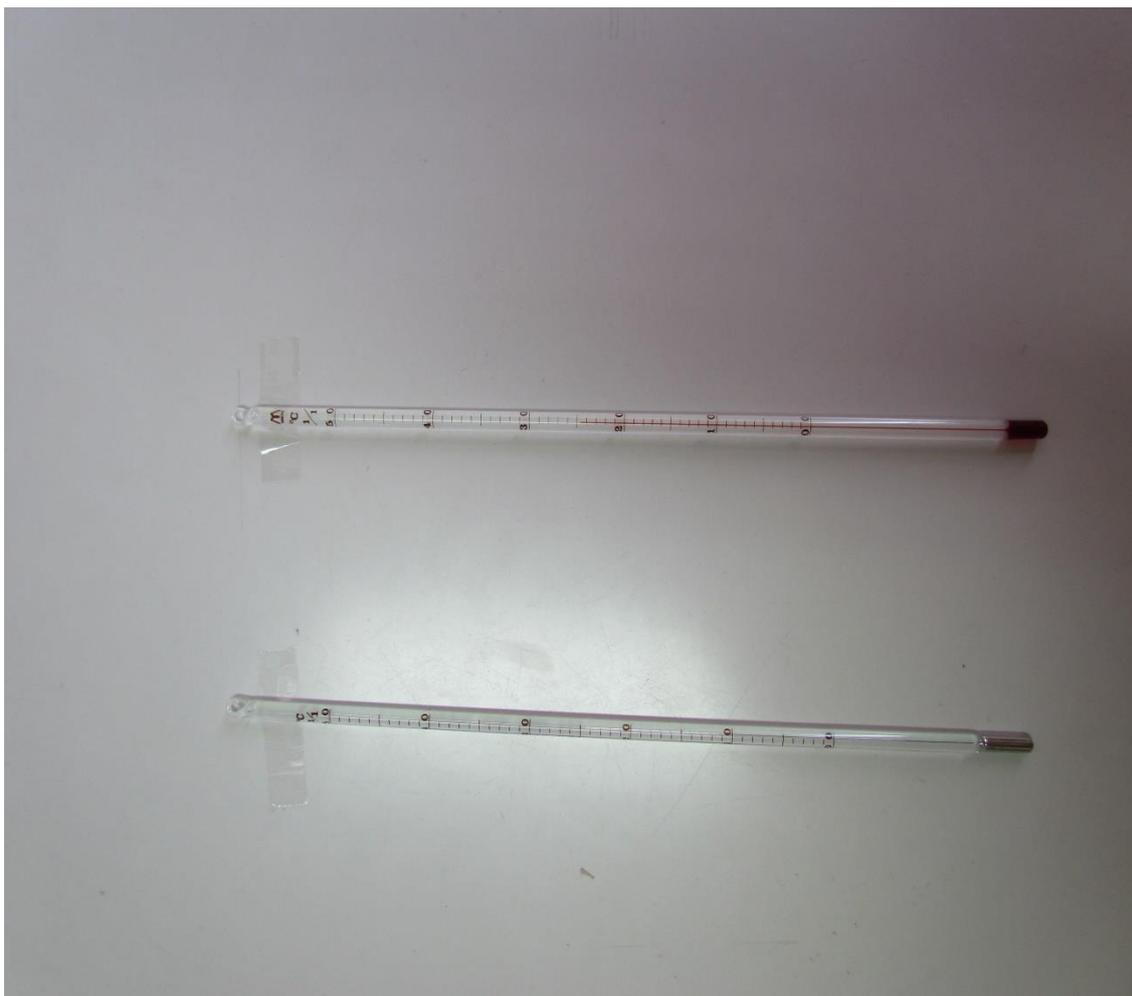
ガラス管の中の毛細管に感温液を封入、目盛は表面に刻まれております。
